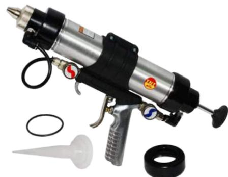
Универсальный пневмопистолет под картриджи и тубы используется для работы с однокомпонентными герметиками всех типов. Путем смены носиков, входящих в комплект пистолета, и настройкой двух регуляторов можно изменять подачу герметика и ширину факела распыления, за счет чего получать различную структуру и ширину герметизирующего шва. Не нуждается в промывке. Отсутствие остаточного давления в картриджах. Картриджи и тубы используются со стандартными носиками, входящими в комплект поставки.
